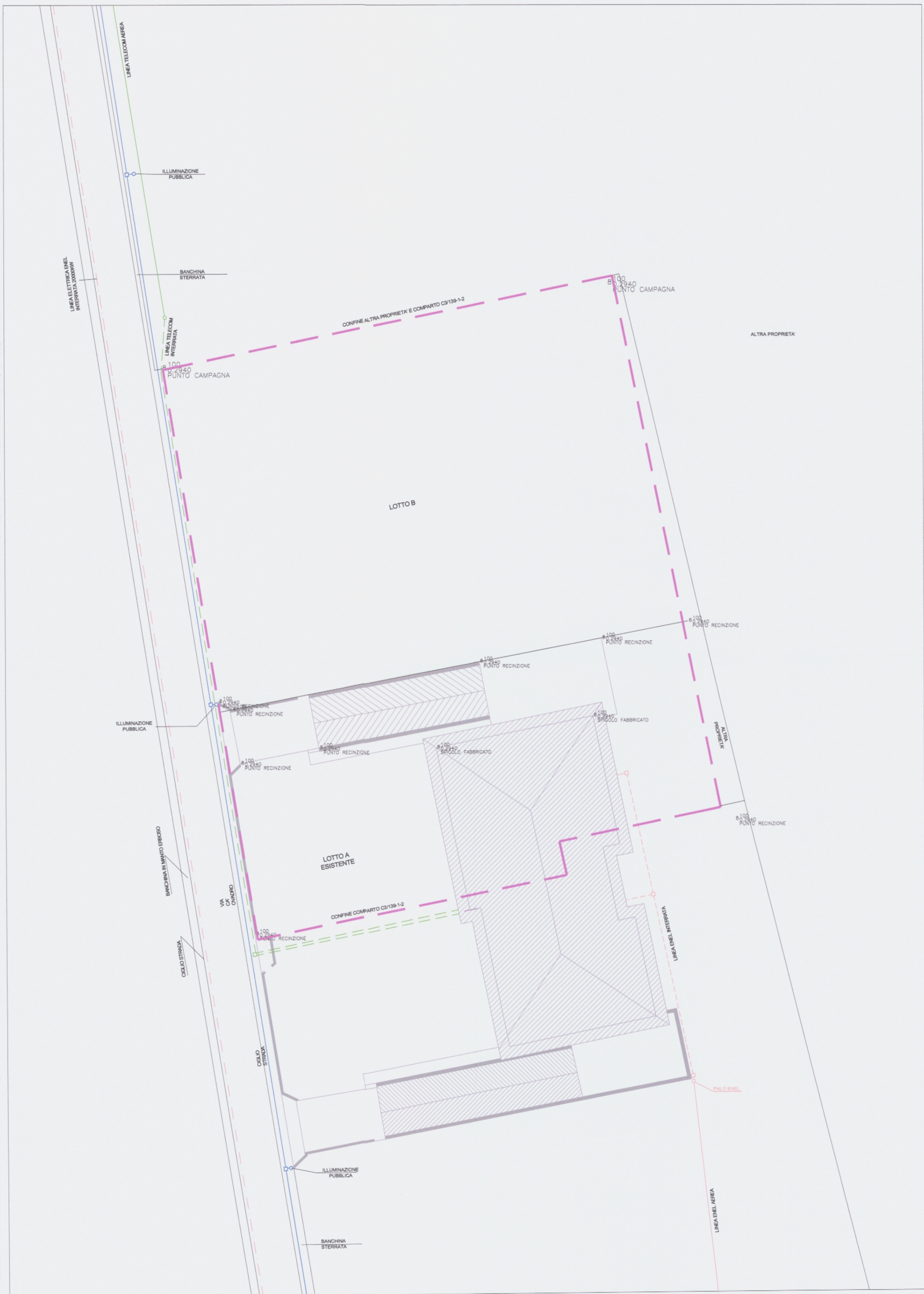
PLANIMETRIA RILIEVO CELERIMETRICO STATO ATTUALE DETTAGLIO RETI TECNOLOGICHE ESISTENTI SCALA 1:200
